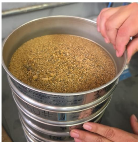
Figura 1- Areia utilizada como agregado miúdo, antes do peneiramento
