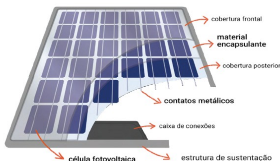
Figura 1 – Composição do módulo fotovoltaico
