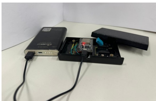
Figura 7: Placa de sensores para instalação na Catedral. Fonte: Autores, 2026.
